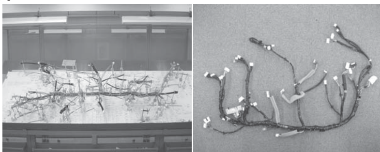
図2. W/H 外観 (左：組み立て状況 右：完成品)
