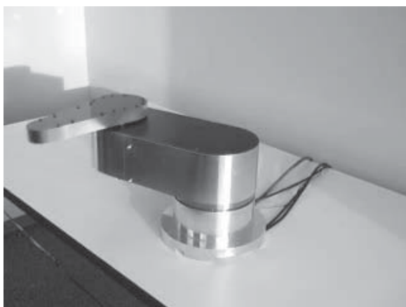
図3 無接触伝送を用いた無限回転 SCARA ロボット
