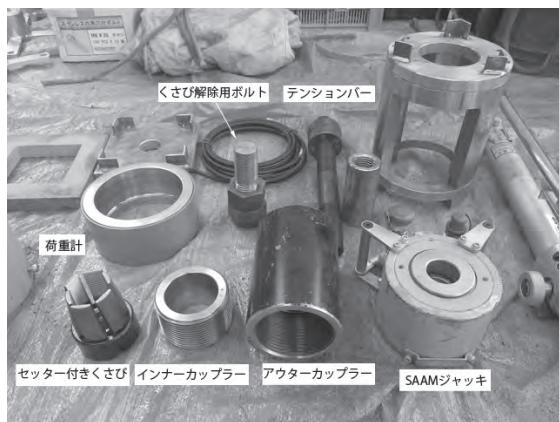
写真-1 再緊張用治具の構成
