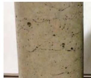
写真2 FA置換率60%の供試体表面の黒色の縞模様
