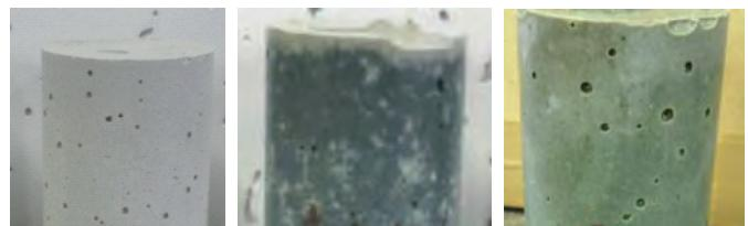
写真3 養生条件の違いによる試験体の色の違い
