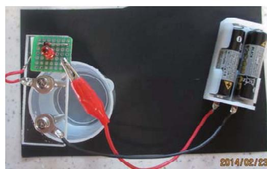
写真3 液体電流チェッカーと試験容器
